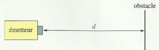
**Doc. 12** Le télémètre permet de mesurer des distances. C'est un émetteur ultrasonore qui envoie une onde vers un obstacle. L'onde se réfléchit et retourne vers l'appareil qui comporte un détecteur.
