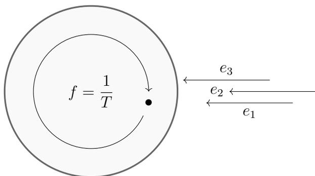
Lorsque :  $f = k.f_e$  où  $k \in \{1, 2, 3, \dots\}$ , on observe l'onde entretenue en immobilité apparente. La fréquence maximale des éclairs est atteinte lorsque  $k = 1$  on aura donc  $f = f_e$ .
