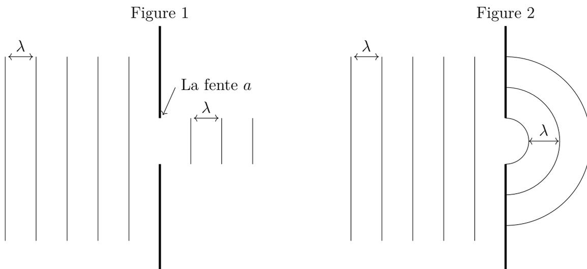
Dans la figure 1 on a  $a > \lambda$ , on remarque que l'onde traverse la fente sans changer la forme, fréquence, vitesse, seulement une partie bloquée. L'onde est dite diaphragmée.
