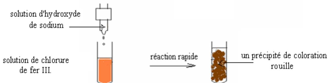
On constate la formation d'un précipité de couleur rouille d'hydroxyde de fer III selon une réaction rapide dont l'équation s'écrit:
