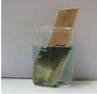
On constate la formation d'un dépôt d'argent sur la partie immergée de la plaque et on constate que la solution prend une coloration bleue caractéristique des ions  $Cu^{2+}$ .
