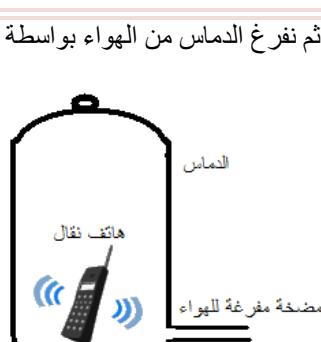
تجربة 1: نشغل الهاتف ، ثم نفرغ الدماس من الهواء بواسطة مضخة مفرغة للهواء
