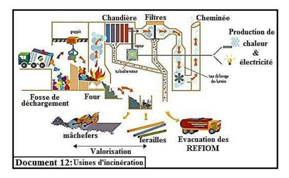
L'incinération a pour objectif la réduction importante du volume des déchets de 90% et permet une production d'énergie.
