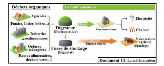
La biométhanisation n'aboutit pas à une dégradation complète des déchets. La matière solide qui reste, appelée digestat est comparable à un compost, elle sera destinée à l'épandage dans les champs agricoles.
