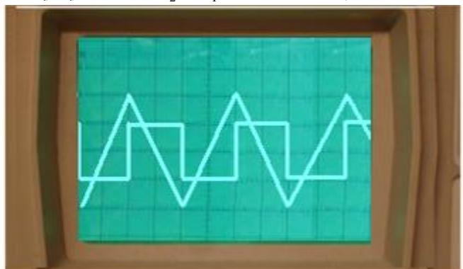
الكسح الأفقي المستعمل:  $0,5ms/div$ . الحساسية الرأسية: بالنسبة للمدخل  $Y_2$ :  $1V/div$  وبالنسبة للمدخل:  $Y_1$ :  $0,05V/div$
