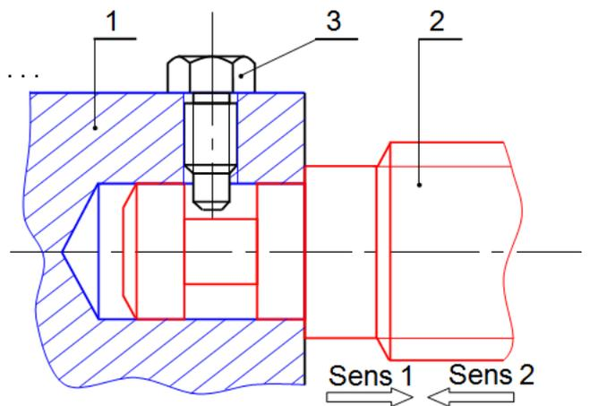
**Critiques :** Moins chère, **faibles vitesses**, **usure des pièces** due au frottement, échauffement important se produirait et des puissances transmissibles modérées.
