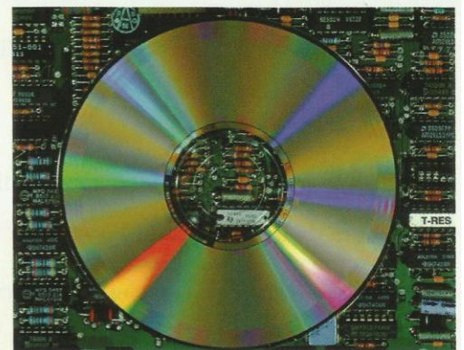
Doc. 7 Les pistes d'un CD permettent de décomposer la lumière blanche par diffraction.
